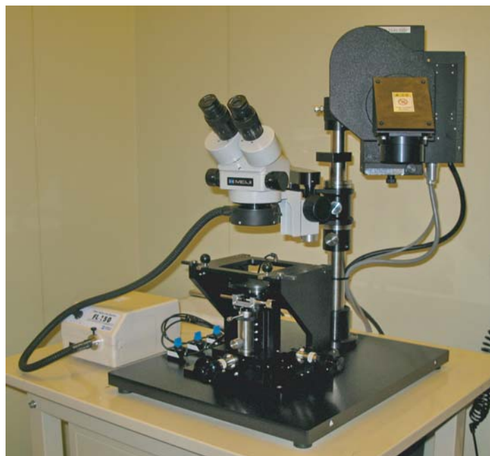
(標準仕様: コリメータレンズUV光源、実体顕微鏡観察タイプ)
